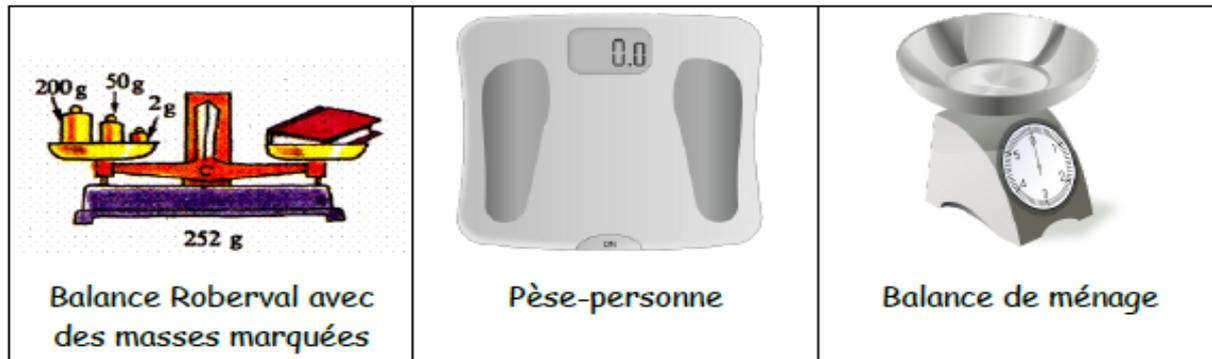
Avec la balance Roberval, on utilise des masses marquées. On équilibre le plateau où est l'objet, avec le plateau de masses marquées. On additionne les masses marquées pour trouver la masse de l'objet.
